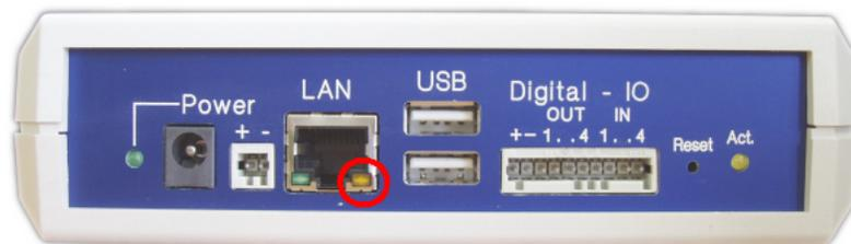
Die physische Verbindung ist okay, falls die gelbe Link-LED bei der RJ45-Buchse leuchtet, wenn das LAN-Kabel verbunden wird. Die Link-LED leuchtet konstant solange die Verbindung besteht. Bei einigen Geräten-Modellen blinkt die LED im Betrieb auch synchron zur grünen Activity-LED an der RJ45-Buchse bei Datenverkehr.
